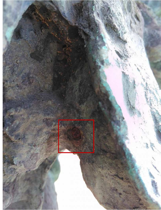
Točkasta hrđa na brončanoj plinti (fotografija gore lijevo) i željezna ispuna evidentirana ispod šinjela sa zapadne strane (unutar pravokutnika) s narančastim oksidima na okolnoj brončanoj stijenci.
