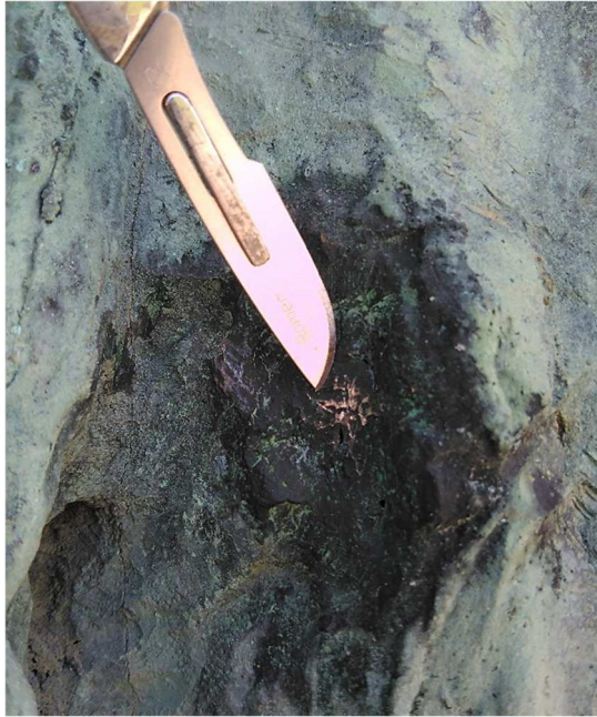
Tragovi olova na brončanoj skulpturi u tankom nanosu kao da je metal „razmazan“ po površini.
