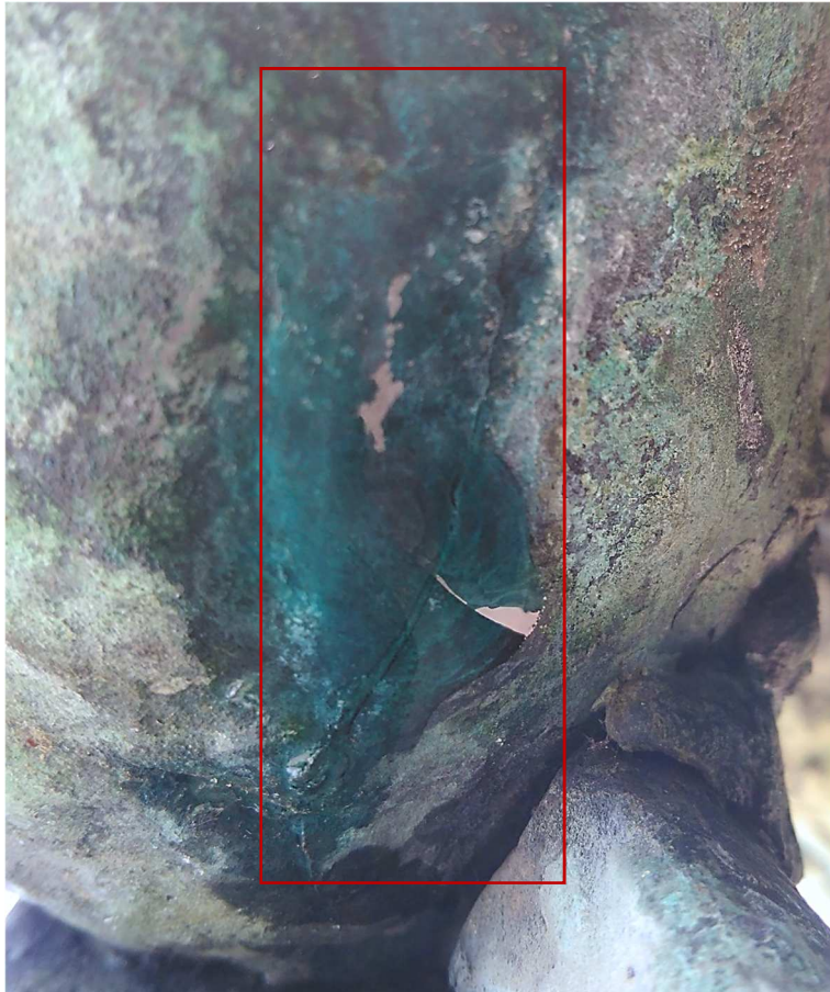
Fotografija napuknuća brončane stijenke i plavičastog kondenzata koji se formirao uzduž napuknuća (unutar pravokutnika)
