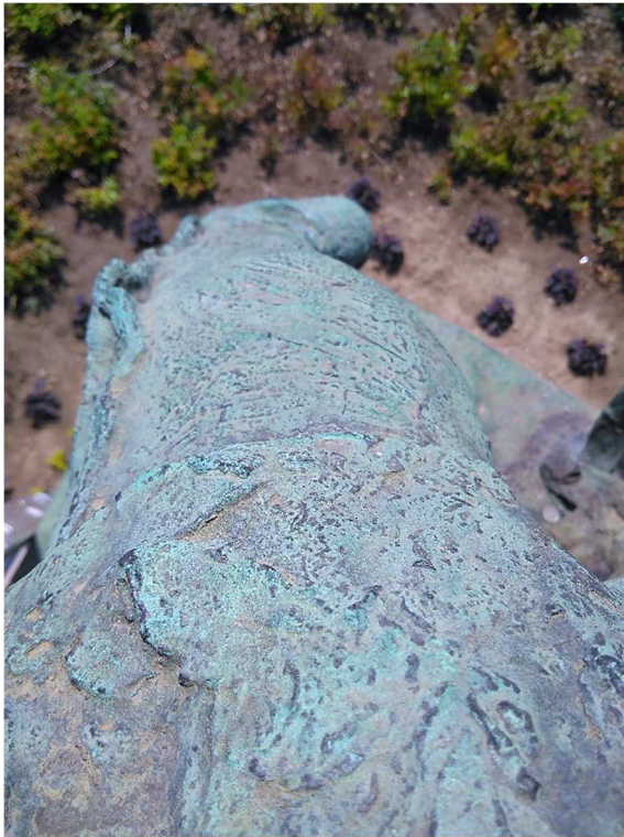
Površine skulpture prekrivene slojem bazičnog bakar sulfata
