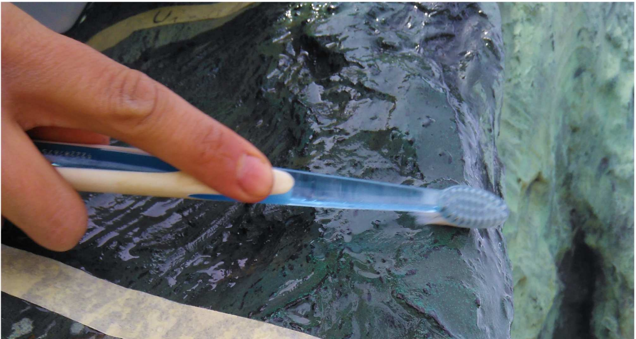
Četkanje i ispiranje površine unutar sonde U 1 u svrhu prikupljanja štetno topivih soli sa površine.
